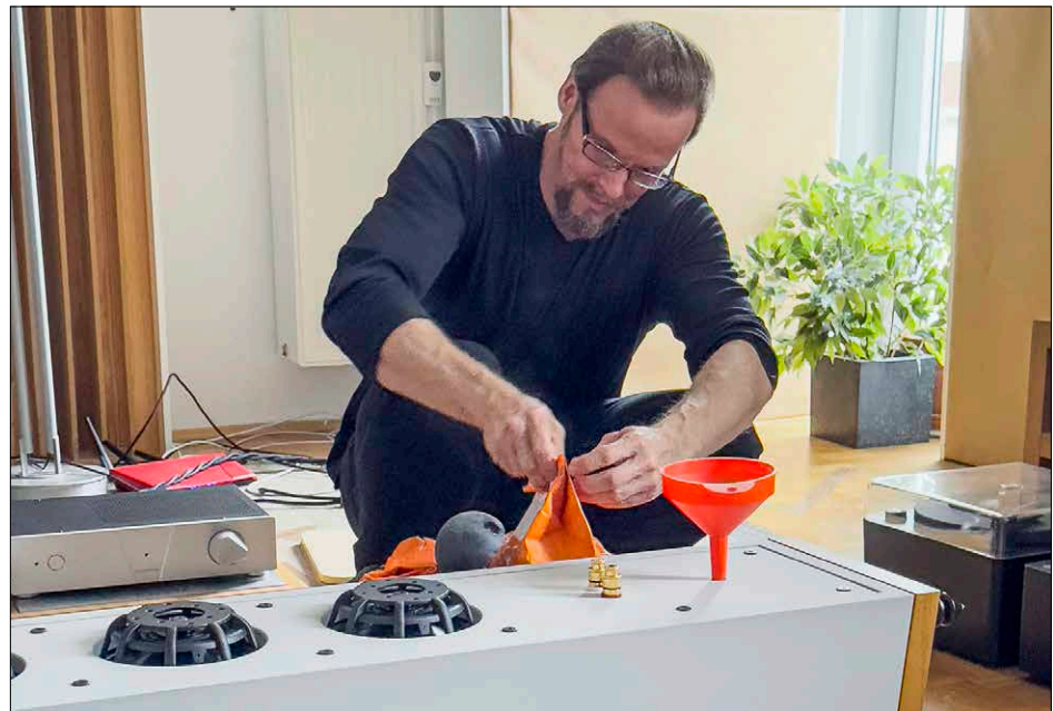
Jörg Weber demonstriert, wie die „Gloria“ noch klanglich zulegt, wenn man die Box über den kleinen Einfüllstutzen per Trichter zusätzlich mit rund 8 Kilo feinem Sand befüllt.
