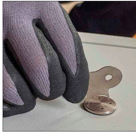
Nach Entfernen der Kappe mit dem Spezialschlüssel lässt sich Sand in die Box füllen.
