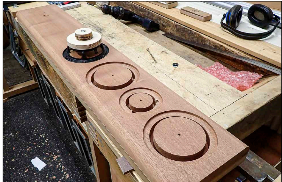
Die aus Massivholz hergestellte Schallwand ist 30 Millimeter dick und wird aus zertifiziertem Holz in einer Schreinerei in aufwendiger Handarbeit fertiggestellt.
